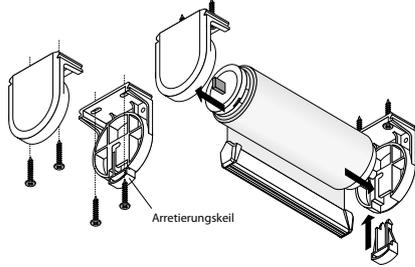
→ Bei Seitenzugrollo mit Bedienseite rechts, die Träger seitenverkehrt montieren!
