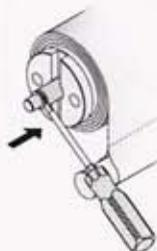
anschließend den Zylinderstift mit einem Schraubendreher in die Rollowelle eindrücken und das Rollo aus den Trägern nehmen
